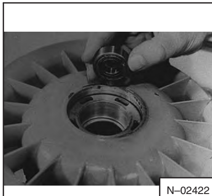
Fig. 7A-30 Removing The Blower Fan
